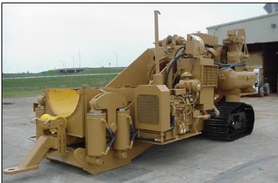
Figura 6 - Máquina do tipo rotatória para curvamento a frio de tubulações [8]
